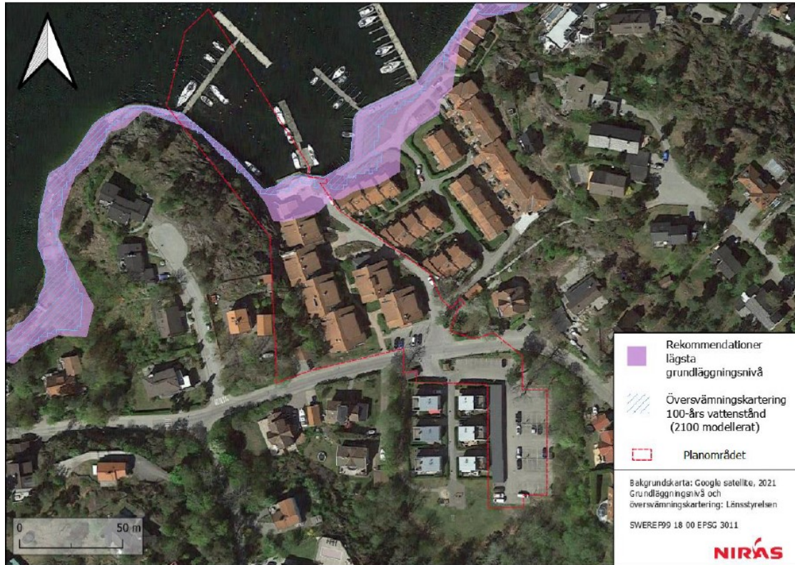
Figur 12. Lila områden ligger under rekommenderad lägsta grundläggningsnivå +2,7 meter RH2000 och framtida scenario för översvämnning vid 100-års vattenstånd, (Niras, 2021).
